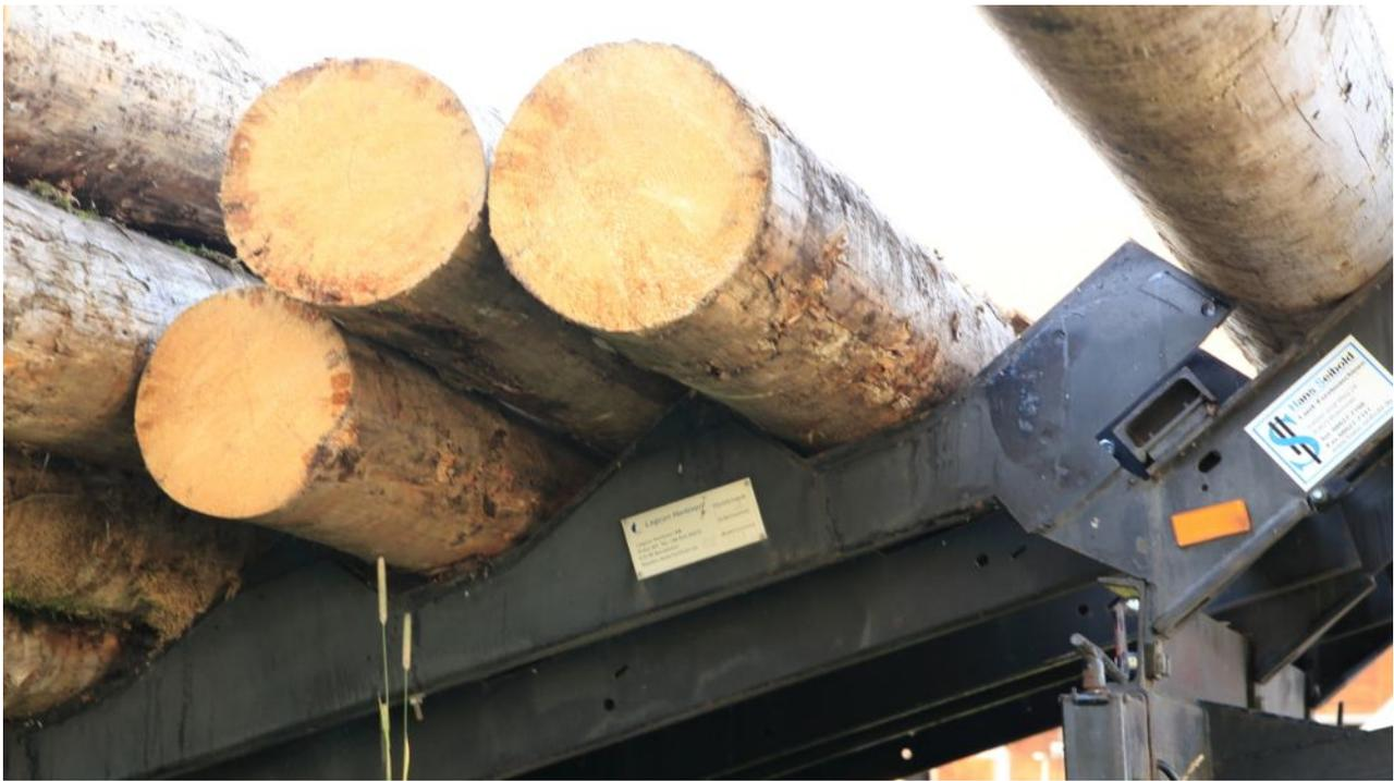
Die Stufenverzahnungen werden am Sägespalter hydraulisch angesteuert.
