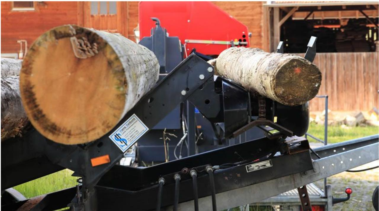
Der Locon-Stufenvereinzeler hebt den Baumstamm zur Kante, bis der Stamm durch sein Eigengewicht sanft auf das Förderband rollt.
