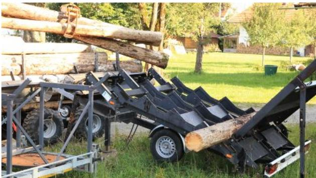
Die versetzten Zahnungen selektieren die Baumstämme und heben diese Stufe für Stufe zur Endkante am Förderband
