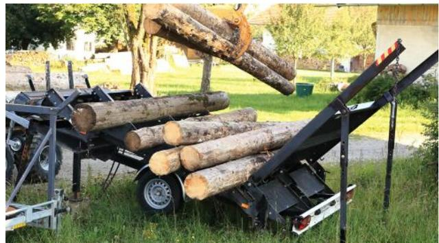
Der Logcon-Stufenvereinzeler fasst das Volumen eines großen Rückeanhängers.
